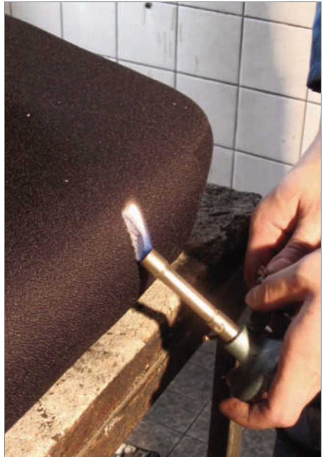
Abbildung 22: Sitzprüfung mit Gasflamme in Anlehnung an ÖNORM EN 1021-2
