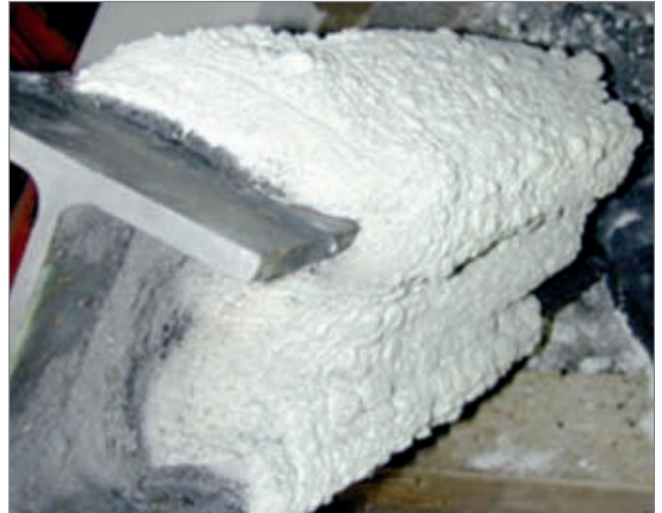
Abbildung 1: Aufgeschäumtes Brandschutzmittel auf einem tragenden Element / Quelle: Brandschutzchemie BSC/
