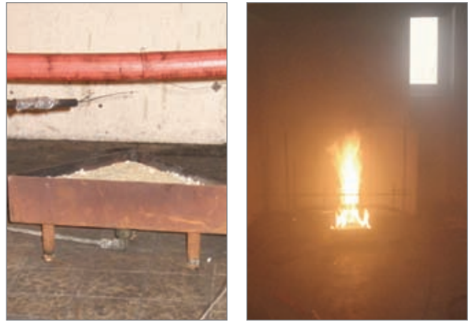
Abbildung 16: Bremsschlauch vor und während Beflammung
