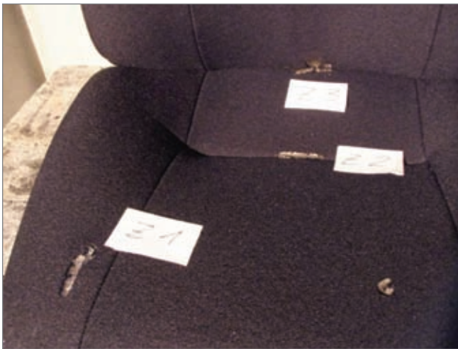
Abbildung 21: Sitz nach Prüfung gemäß ÖNORM EN 1021-2 mit glimmenden Zigaretten (Z1 bis Z3)
