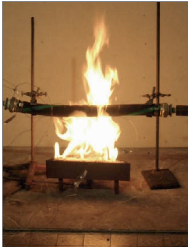
Abbildung 14: Bremserschlauch während der Prüfung
