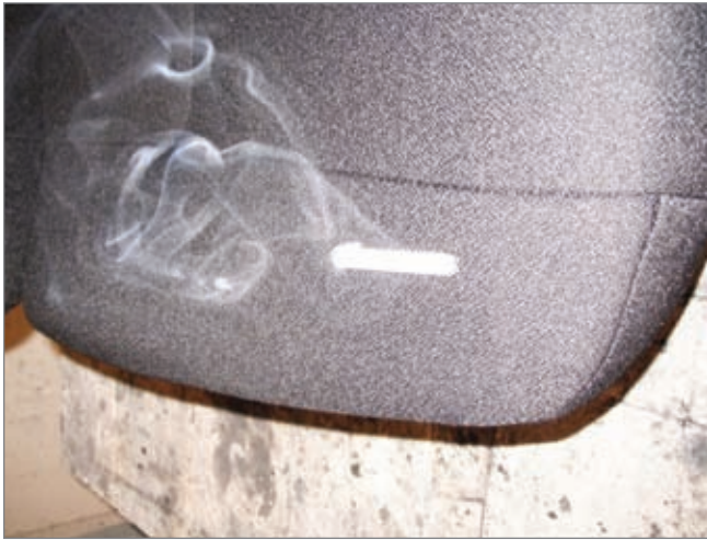
Abbildung 20: Prüfung eines Sitzes mit einer glimmenden Zigarette
